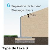
Paramètres de sol pour 1,2, 3: 1800kg/m³; angle de friction interne 32,5° 1800kg/m³; angle de friction interne 35° Paramètres de sol pour 4,5: Paramètres du sous-sol: 1900kg/m³; angle de friction interne 35° DB: Distance au bord HR: Hauteur de remplissage Pas besoin de béton ou de sable de stabilisation
